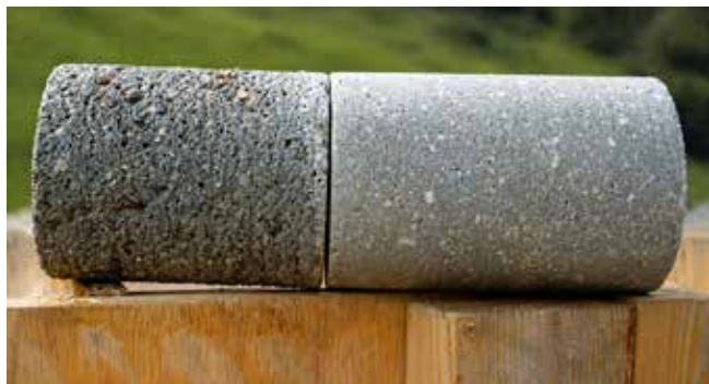
Fig. 1: Dos núcleos (realizados por dos lanzadores diferentes con la misma mezcla de concreto) producen resultados muy distintos.
