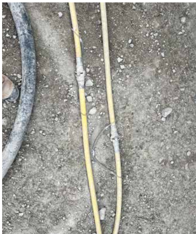
Fig. 1 y 2: Comprobaciones de latigazos instaladas en el material y las líneas aéreas para sujetarlas en caso de desconexión.
