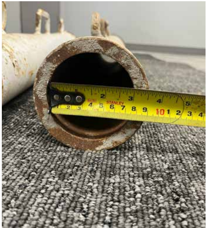
Figs. 6 y 7: Al comparar las tuberías nuevas y usadas una al lado de la otra, se aprecia una diferencia notable en el diámetro. Tras medirlas, queda claro que la tubería usada es ligeramente más grande.
