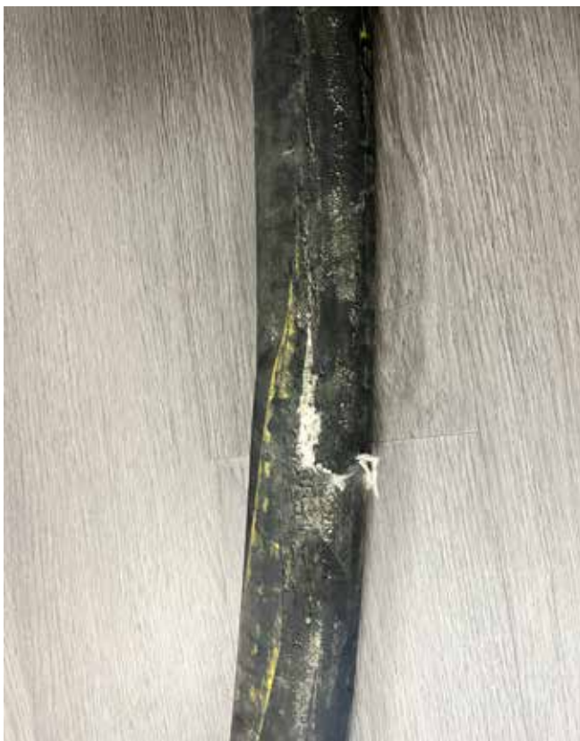
Fig. 4: Esta línea de material sufrió una ruptura; tras inspeccionarla, se observó que esta sección presentaba claras hendiduras. Probablemente, estas fueron causadas por el roce repetido contra las barras de refuerzo. Esto provocó un debilitamiento de la sección de la línea, que se rompió durante un tapón.
