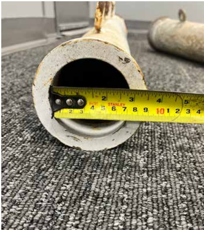
Figs. 6 y 7: Al comparar las tuberías nuevas y usadas una al lado de la otra, se aprecia una diferencia notable en el diámetro. Tras medirlas, queda claro que la tubería usada es ligeramente más grande.
