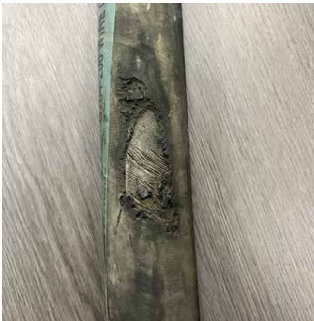
Fig. 3: Las mangueras «Down line», que están conectadas al reductor de la bomba, están trenzadas con alambre para soportar una mayor presión. Esta manguera en particular muestra una zona claramente desgastada, probablemente causada por el contacto repetido con un pilón soldado.
