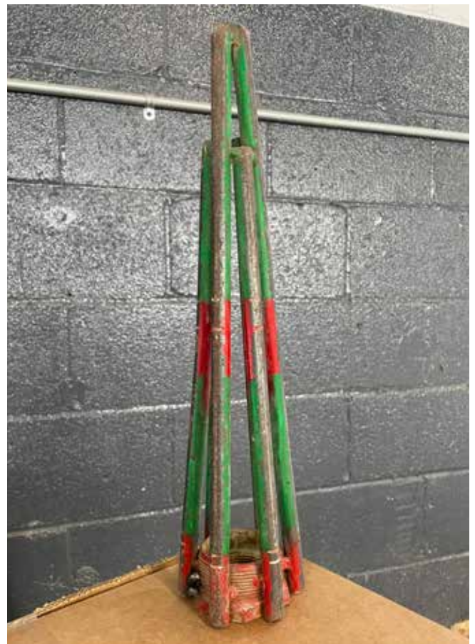
Fig. 8: Consolidated Shotcrete diseñó una herramienta de inspección para evaluar el estado de las tuberías y determinar los criterios de fin de vida útil.
