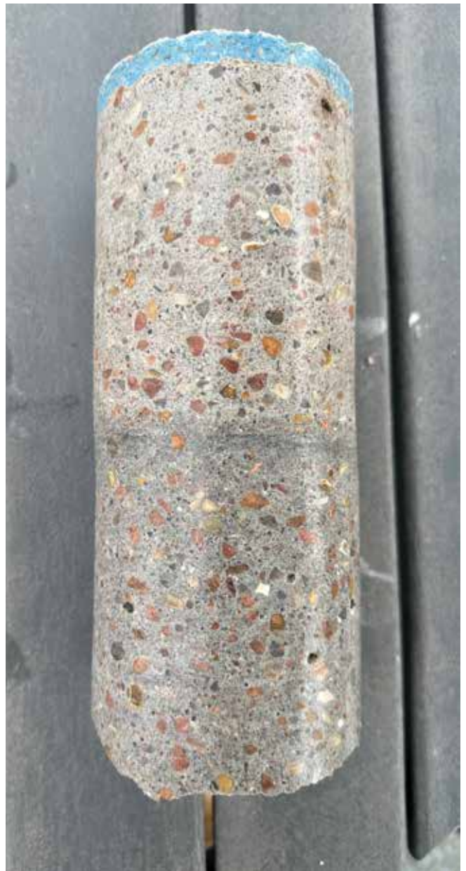
Fig. 1: Muestra de núcleo tomada en el piso de una alberca cerca del cove, mostrando capas sin consolidar.
