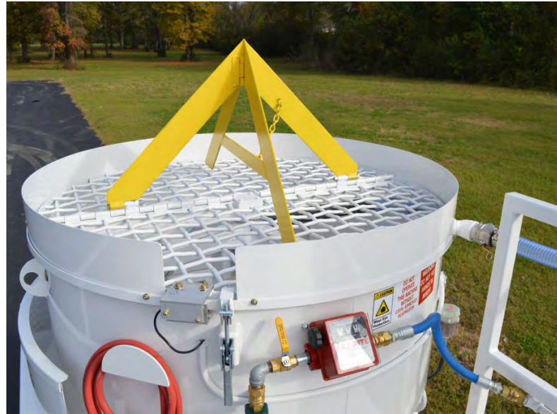
Fig. 4: Cortadora de bolsas para 2.200 bolsas a granel de refractario preenvasado
