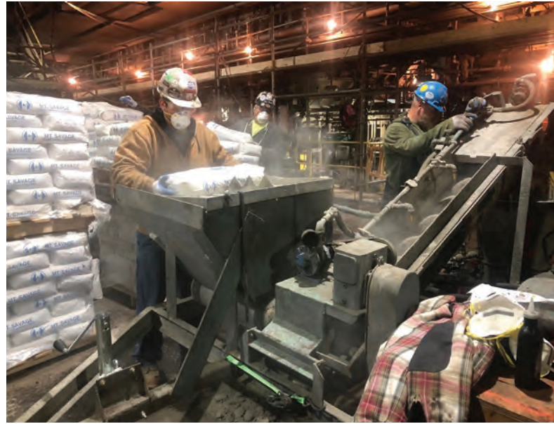
Fig. 5: Trabajadores alimentando refractario preenvasado
