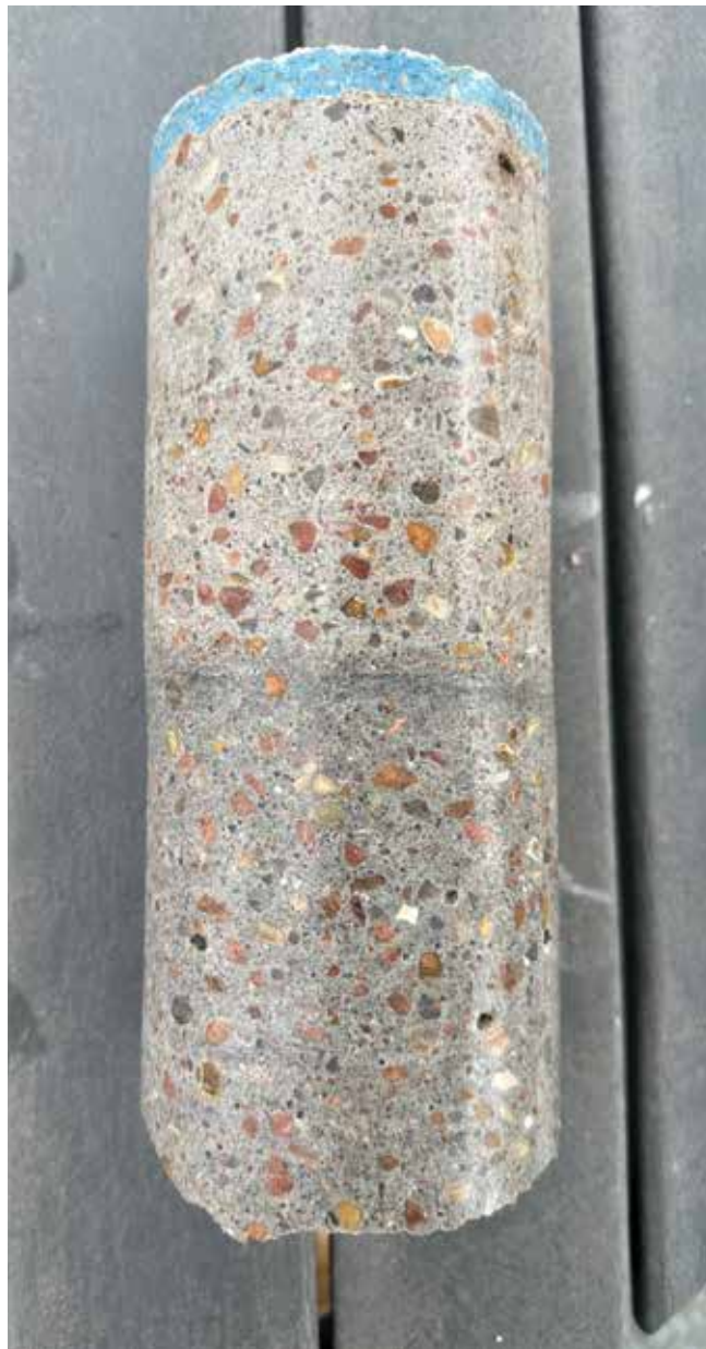
Fig. 1: Muestra de núcleo tomada en el piso de una alberca cerca del cove, mostrando capas sin consolidar.
