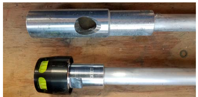
Fig. 4: Boquilla Venturi y boquilla reductora de ruido
