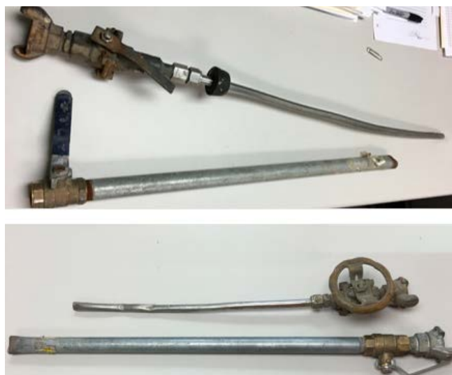
Fig. 1: Diferentes lanzas de aire que no cumplen con las normas
