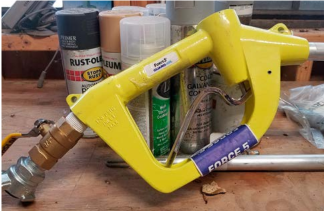
Fig. 3: Gatillo de hombre muerto con válvula de bola instalada para ajustar el volumen
