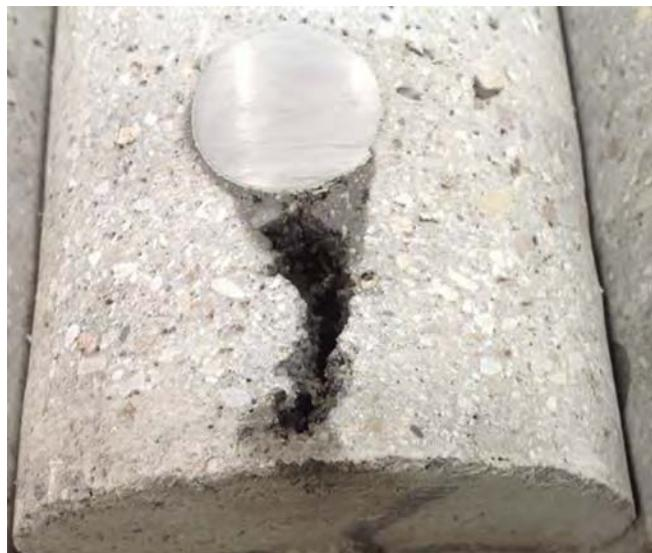
Fig. 2: El principal defecto de este núcleo es evidencia de un flujo inadecuado durante la colocación.
