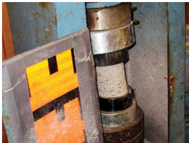
Fig. 2: Muestra que no ha sido cortada a 90 grados en una máquina de rotura
