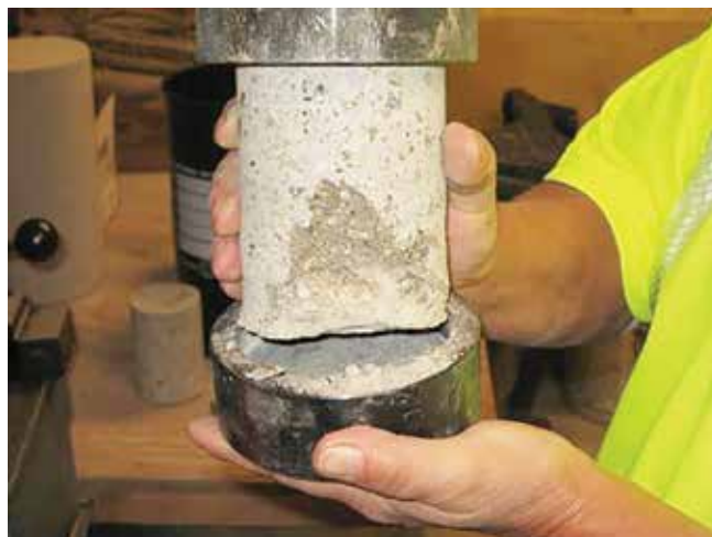
Fig. 3: Tipo de rotura que indica una carga puntual como resultado de un núcleo que no ha sido cortado a 90 grados
