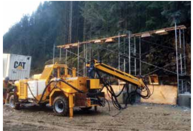
Fig. 5: Putzmeister SPM 4210 robotic sprayer
